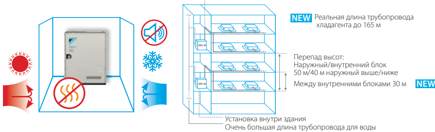
Допускается вертикальная установка блоков
